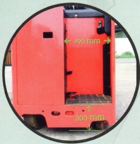
Wide operation space and low-pedal would reduce operator's fatigue พื้นที่สำหรับผู้ปฏิบัติงานกว้างขวาง
